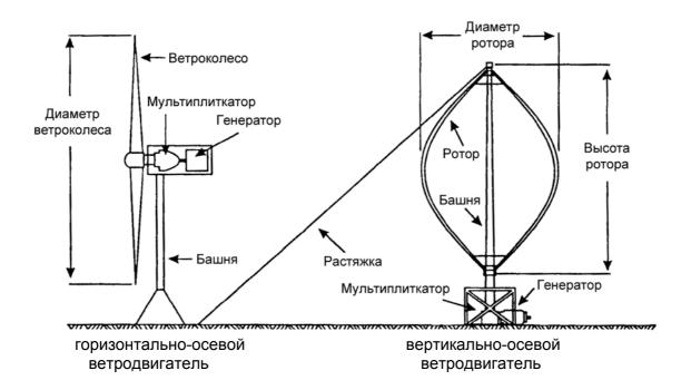
Кроме того, для защиты от поломок при сильных порывах ветра и ураганах почти все ВЭУ большой мощности автоматически останавливаются, если скорость ветра превышает предельную величину. Для целей обслуживания они должны оснащаться тормозным устройством. Горизонтально-осевые ВЭУ имеют в своем составе устройство, обеспечивающее автоматическую ориентацию ветроколеса по направлению ветра.
