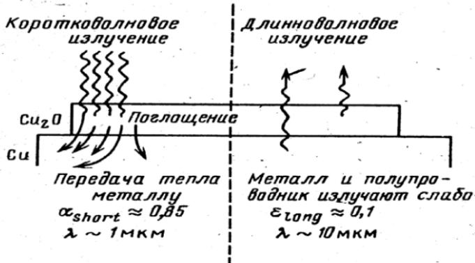
Рис. 1.4. Тепловые потоки для селективной поверхности абсорбера
