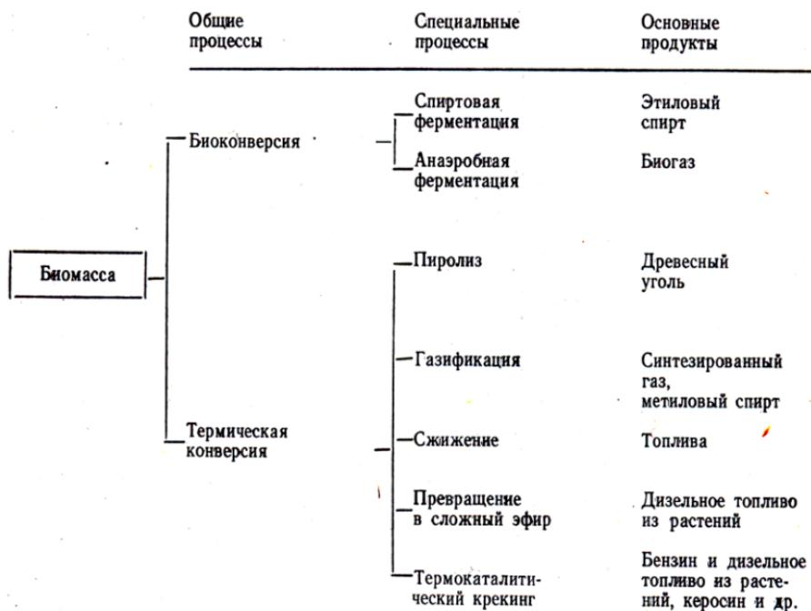
Рис. 4.2. Классификация технологий преобразования энергии биомассы
