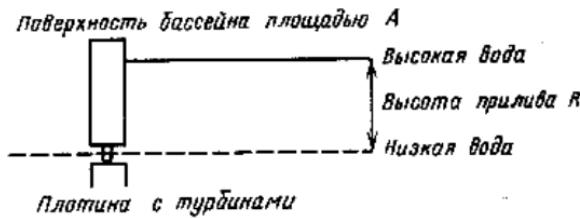
Рис. 7.3. Схема извлечения приливной энергии
