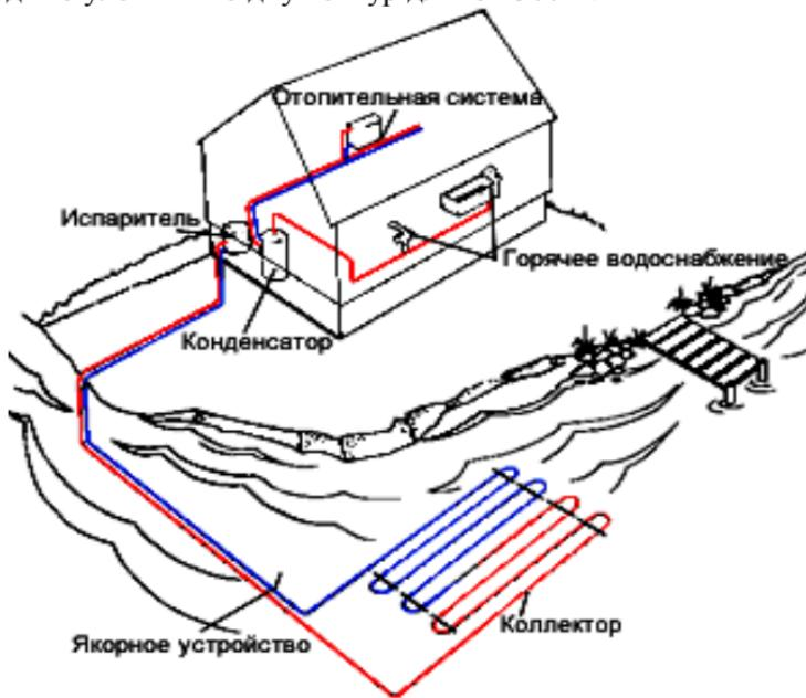
Рис. 6.8. Схема отопления с использованием тепла водоёма
