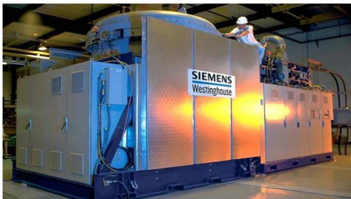
Рис. 10.8. Стационарная силовая установка на топливных элементах производства компании Siemens (Германия)
