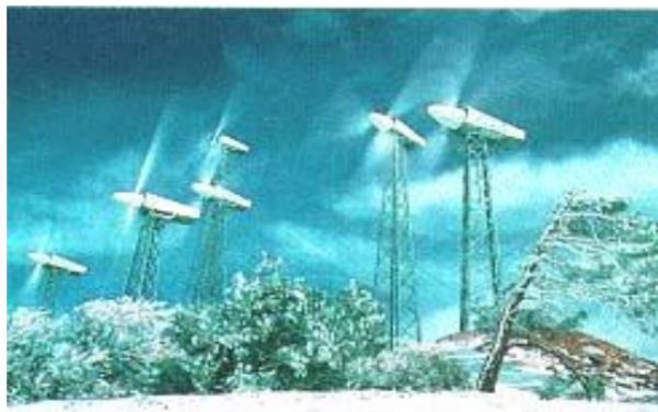
Рис. 2.9. Крыльчатые ветродвигатели с расположением всех узлов в головке, смонтированной на поворотной опоре башни
