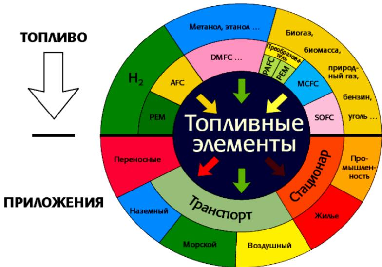
Рис. 10.6. Технологии топливных элементов, предлагаемые топлива и приложения
