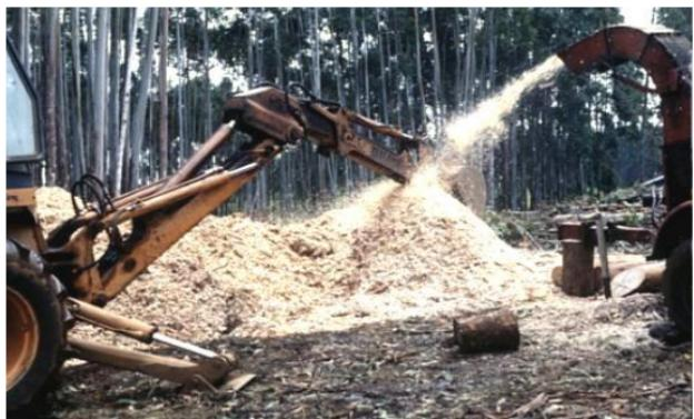
Рис. 4.4. Приготовление древесной щепы рубительной машиной
