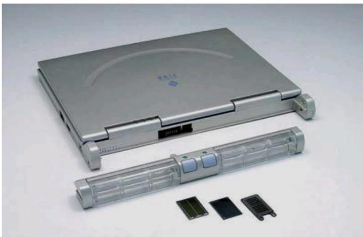
Рис. 10.9. Ноутбук и источник питания (топливные элементы с ионообменной мембранный) фирмы Casio (Япония)
