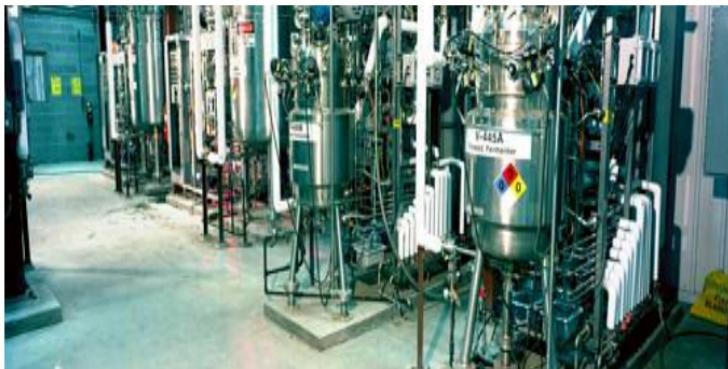
Рис. 4.12. Установка для производства топливного этанола
